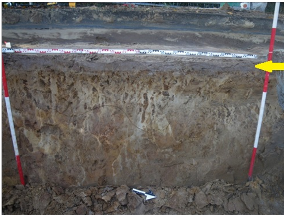
Afbeelding 4. Profiel 12 Mottenbrink. Van boven naar beneden bestaat de bodem uit asfalt, een puinlaag, een oud wegoppervlak (grijs, bij de gele pijl) en uit dekzand op keileem
